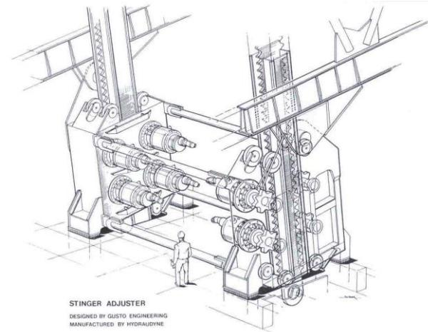
Редукторы привода системы регулирования хвостовика
